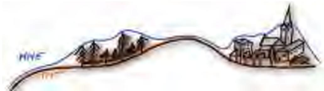
Figure 78 : Modèle Numérique de Terrain et Modèle Numérique d'Élévation
